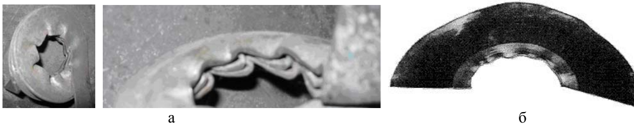
Рис. 1. Гвинтові заготовки з гофрама на внутрішніх крайках витків: а – навивні заготовки; б – прокатна заготовка
